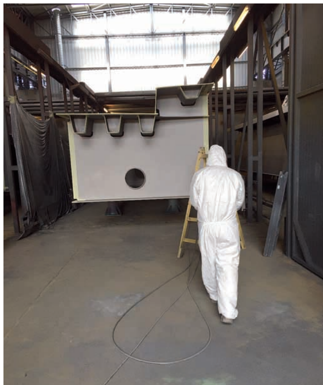
144. ábra: Gyári festés felhordása Dunakeszin
