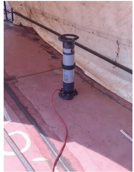
72. ábra: Varratok röntgensugaras vizsgálata
