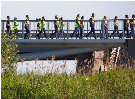
Tiszafürdei kerékpáros Szomorka-patak-híd próbaterhelése 2020. május 22-én (Gyukics Péter felvétele)
